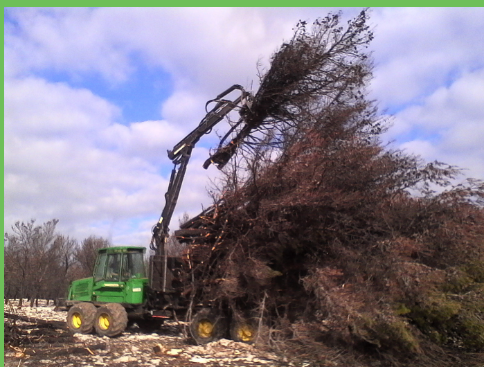
Débardage des arbres entiers par porteur
